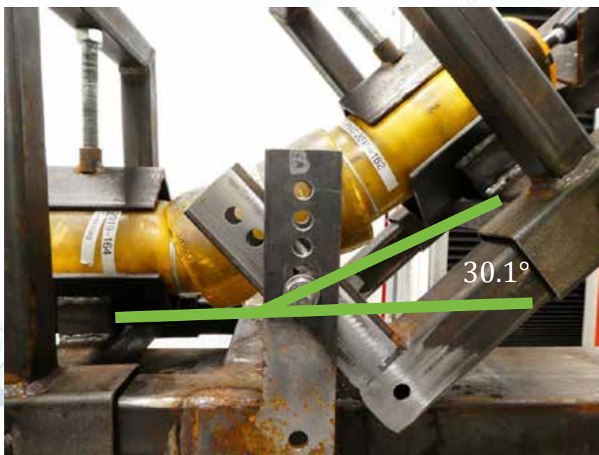
شکل ۳. حداکثر زاویه انحرافی که دستگاه آزمایش به آن رسید. هیچ نشت اتفاق نیفتاد.
